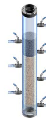
Figura 1. Filtro de arena de medio dual
