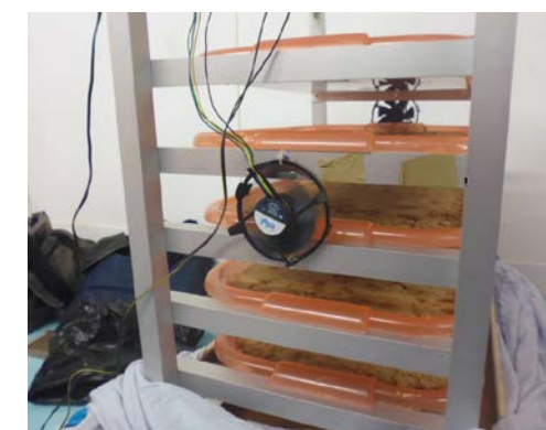
Figura 2. Estructura metálica a escala con 2 extractores de aire, la cual almacena las charolas con las larvas Anastrepha ludens
