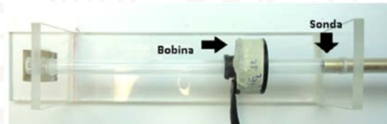
Figura 3. Estructura para montar en el exterior a las bobinas y a la sonda del magnetómetro
