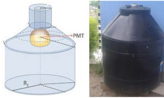
Figura 2. Tanque prueba de LAGO. a) Esquema (modificado de [6]). b) Instalado en la FCFM
