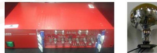
Figura 3. a) Equipo de adquisición de señales CAEN. b) PMT Photonis 9"
