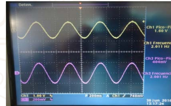
Figura 4. Oscilograma que muestra la señal con la que se estimula a una bobina (arriba amarillo) y la respuesta del magnetómetro a este estímulo (abajo rosa)
